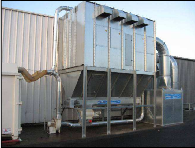
Filtre à vis à décolmatage par vibreur
