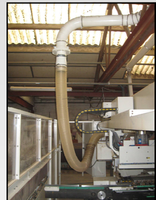
Raccord tournant Evite les torsions des flexibles
