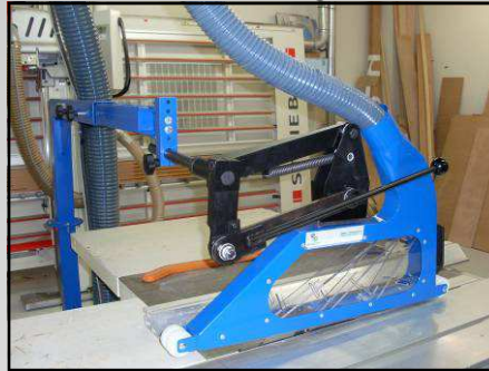
Cape d'aspiration pour scie circulaire Produit breveté étudié en partenariat avec l'
