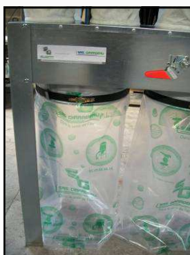
Sacs de récupération de copeaux et de poussières de bois
