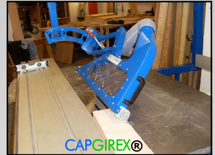
Cape de scie à format inclinable de 0 à 46°, produit breveté par
