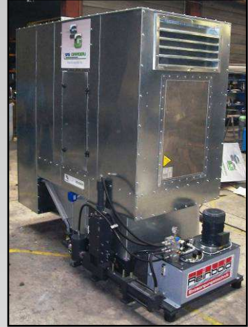
Filtre mobile avec presse à briquettes intégrée
