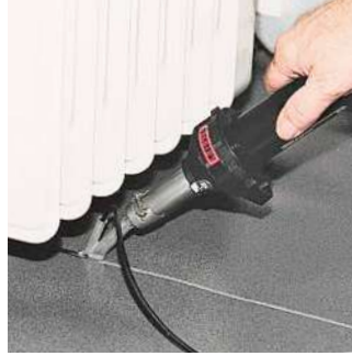
Le HOT JET S convient parfaitement pour le soudage des endroits difficiles d'accès.
