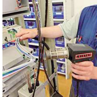
Réchauffage de faisceaux de fibres de verre pour faciliter l'usinage.
