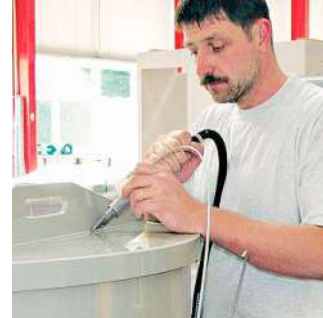
Soufflerie ROBUST pour alimentation en air du WELDING PEN.
