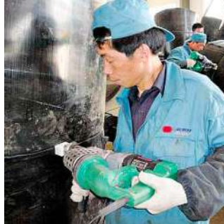
La FUSION 2 à l'œuvre pour la construction de réservoirs.
