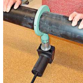
Soudage au miroir de tubes.
