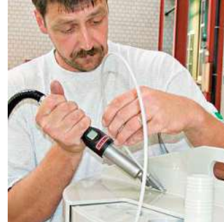
Soudage par fil avec le WELDING PEN R compact et léger.
