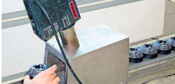
Le HOTWIND S convient parfaitement pour le séchage et la fixation de peinture sur les pièces en plastique.
