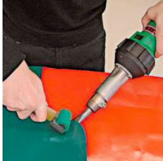
TRIAN PID : Température de soudage contrôlée pour une qualité parfaite.
