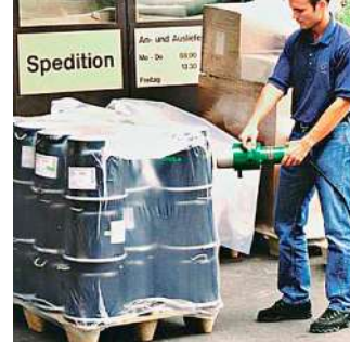
Thermorétraction sans flammes de palettes et de marchandises encombrantes dans des pièces fermées.
