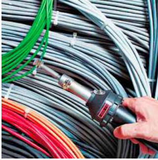
Pose d'un raccord fretté avec le modèle HOT JET S et réflecteur à tamis emboîté.
