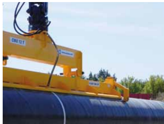
Palonnier porte tube autonome sur pelle Liebherr
