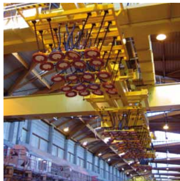
Palonnier extensible pour tôle aluminium haute température (300°) - CMU : 10T.
