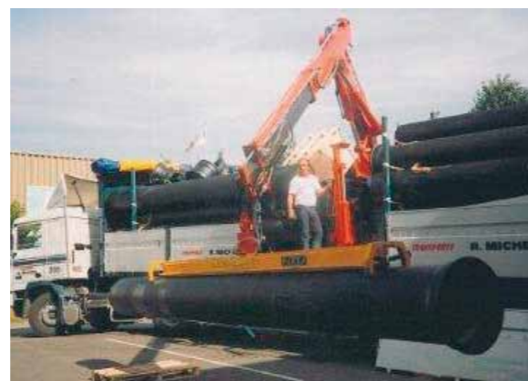
Palonnier porte tube autonome sur grue de camion
