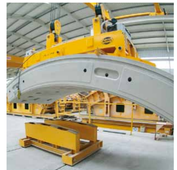
Palonnier porte voussoirs béton
