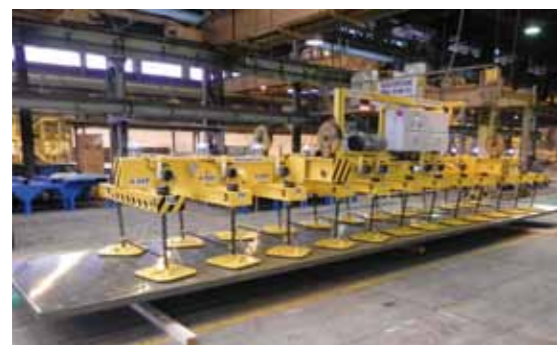
Palonnier à ventouses pour manutention de tôle aluminium - CMU 9T.
