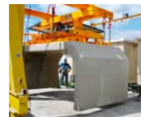
Démoulage, basculement pour murs et voussoirs de route
