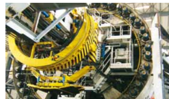
Érecteur à voussoirs pour TBM
