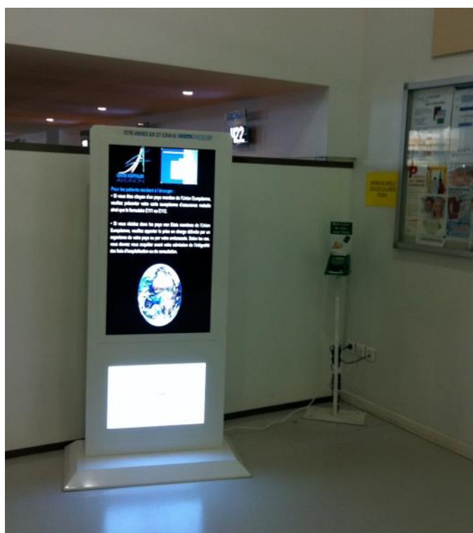
Ecran 32 pouces en vertical et Inséré dans caisson en acier
