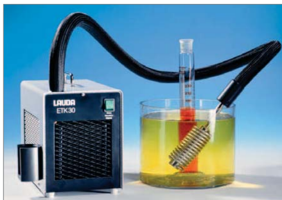
Refroidissement avec un cryoplongeur LAUDA ETK 30
