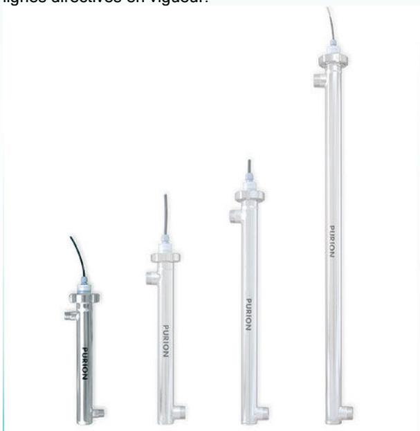
L'installation PURION 500 est livrée en acier électropli. Elle est à utiliser pour la stérilisation de l'eau potable pour une capacité allant jusqu'à 400 l/h de capacité et pour une transmission (ou diffusion aussi) de l'eau d'au moins 90% par cm.
