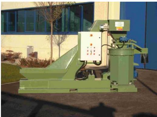
Convoyeur + crible séparateur +essoreuse : 100 kg/h
