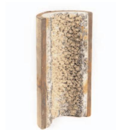
Contre les dépôts minéraux, une solution REP : IDOS, pour traitement par squeeze et en surface.
