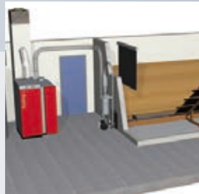
Système d'extraction à vis sans fin et aspiration
