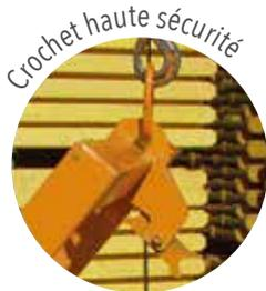
Système de verrouillage pour le vidage automatique de la benne sans assistance au sol, grâce à son palonnier rabattable. Anneau de suspension. Un matériel particulièrement adapté au remplissage par de petits engins de chantier.
