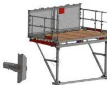
Mettre en place le bracon horizontal et le verrouiller pour maintenir en sécurité la PTE dans sa position ouverte.
