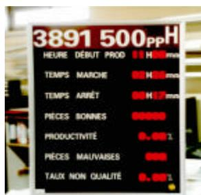
L'afficheur industriel modèle AIGP est destiné à la gestion de production sur les chaînes de montage ou d'assemblage de pièces ou de sous-ensembles.
