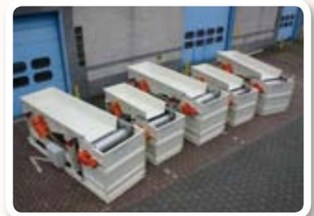
*Les séparateurs à haut gradient Neoflux® sont configurés pour le transport et servent à séparer les particules acier inoxydable faiblement magnétiques des cliquetis.*
