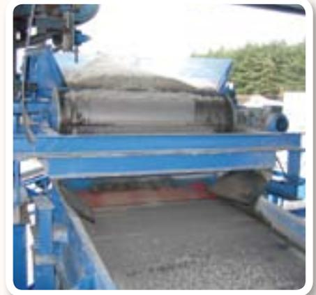
*Un aimant à tambour Neoflux® pour attraper les pièces ferreuses de 0-10 mm au cours d'un processus de recyclage du verre.*
