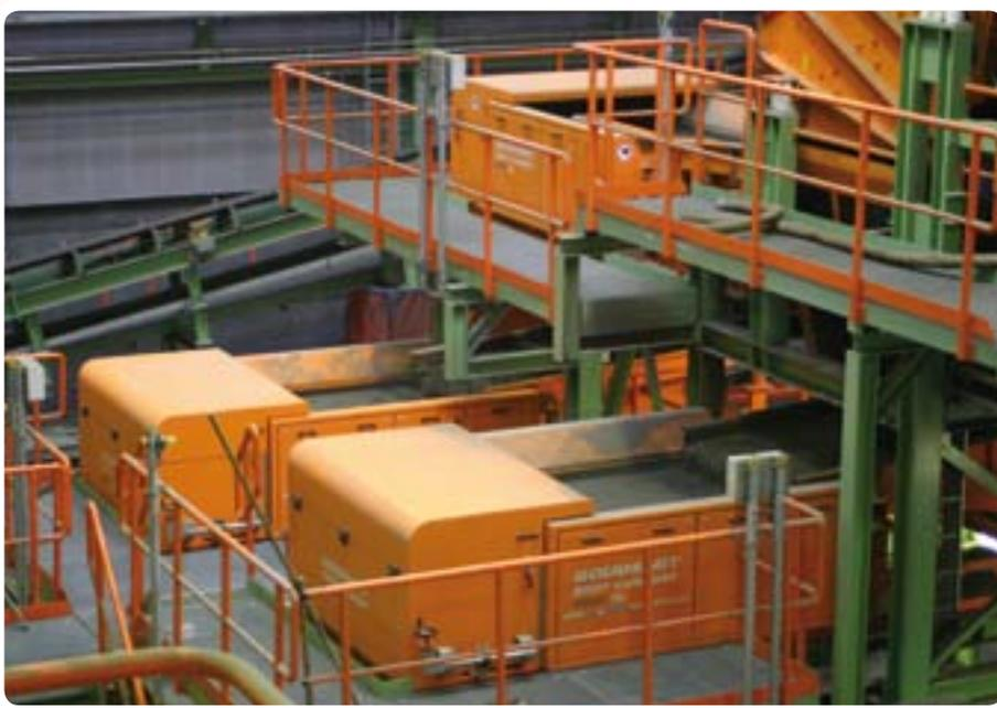
*La disposition en trois phases des **séparateurs de non-ferreux** retire les particules non-ferreuses de 2-5 mm des scories de combustion et prend en charge un degré élevé de séparation, permettant ainsi de réduire les coûts.*
