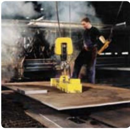
**Electro-Aimant de levage** pour les plaques d'acier.
