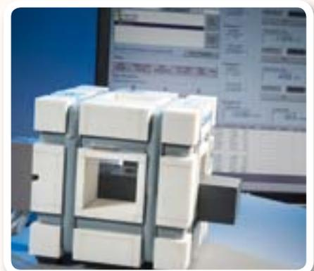
*Goudsmit Supplies possède une bobine de Helmholtz 3D qui peut être utilisée pour mesurer l'angle de magnétisation.*
