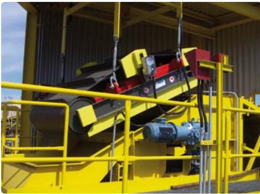
*Electro-aimant pour bande supérieure pour la centrale électrique alimentée en biomasse.*
