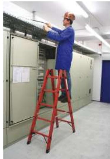
Plate-forme de travail en fibre de verre avec composantes aluminium
