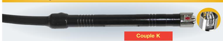
Thermocouple K de surface à lamelles
