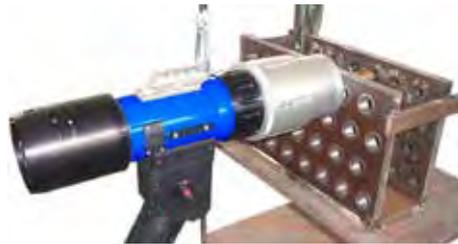
Torche intérieure : Pour le soudage de tubes en retrait et d'applications d'arrière de plaque
