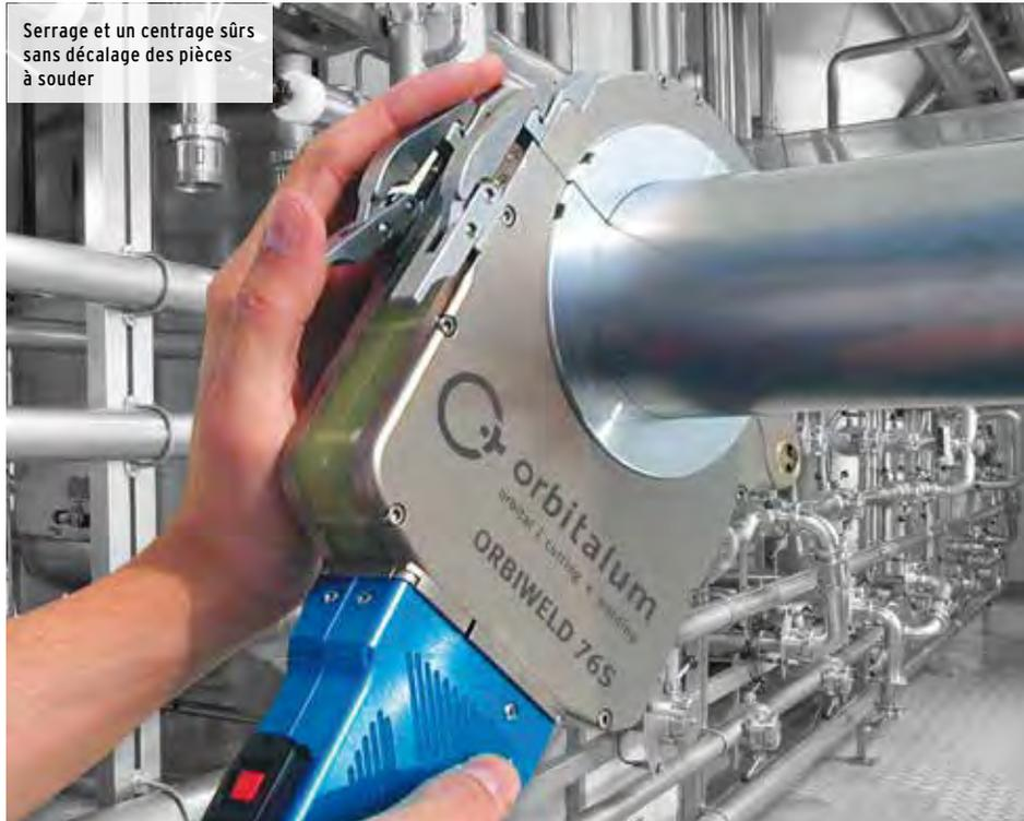
Serrage et un centrage sûrs sans décalage des pièces à souder
