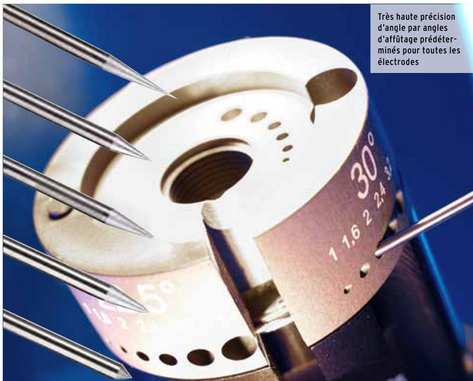
Très haute précision d'angle par angles d'affûtage prédéterminés pour toutes les électrodes
