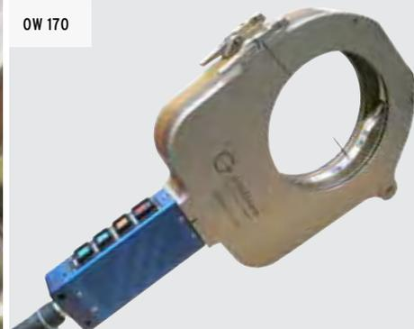
**Avec des canaux de refroidissement traversant complètement l'ensemble du corps de la tête de soudage, nous avons créé une excellente évacuation de la chaleur qui, même pour des courants de soudage élevés et une sollicitation intensive, permet un travail continu avec les têtes de soudage ORBIWELD.**
