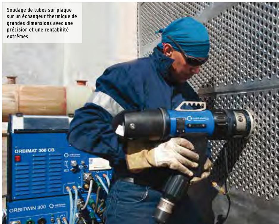
Soudage de tubes sur plaque sur un échangeur thermique de grandes dimensions avec une précision et une rentabilité extrêmes
