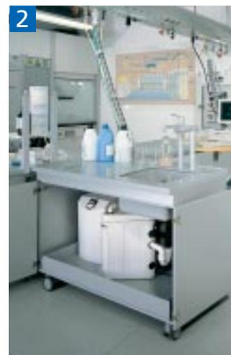
**1** Paillasse pour appareils d'analyses en forme de «U» avec espace disponible pour accès à la maintenance, gaz purs, informatique, alimentation électrique et aspiration ponctuelle par l'aile d'énergie
