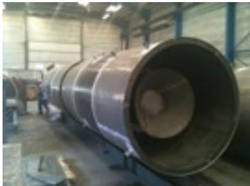
**CNIM - silencieux vapeur** : Ø 2,30m , long : 10,20m, poids : 6,7T, débit max : 130m³/sec à 370°
