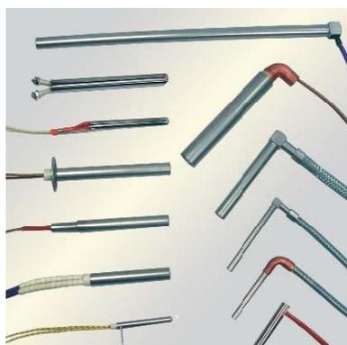
Les cartouches chauffantes permettent de porter à température, très rapidement, des masses solides par conduction, des liquides ou des gaz par convection. Sous certaines conditions, elles peuvent être utilisées jusqu'à 700°C.
