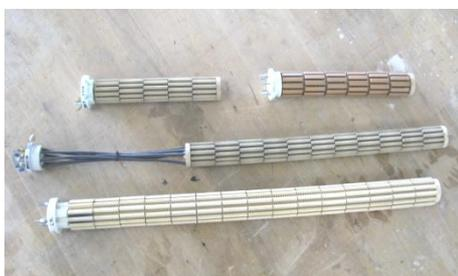
Constituée de fils boudinés en fer chrome alu ou nickel chrome 80/20 répartis dans les logements d'un empilage de barillets en stéatite, elle se termine par des bornes filetées de connexion ou des tresses nickel sous perles ou gainées soie de verre.
