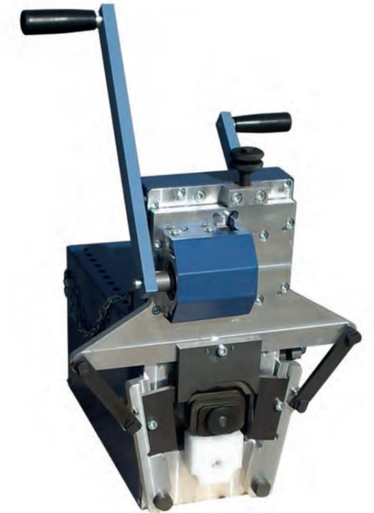
Permet de réaliser vos coudes et déviements sur mesure directement sur chantier.
