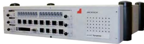
Les simulateurs RNIS BLINK2 / BLINK4 et SYMPHONY permettent de simuler de façon réaliste de deux à huit accès de base RNIS ou RTC et huit accès primaires pour tous vos besoins de test, configuration, démonstration et formation.
