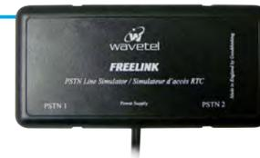
Le simulateur de ligne RTC FREELINK est doté de deux ports permettant d'interconnecter simplement des terminaux analogiques (modem, fax ou téléphone) afin de faciliter vos démonstrations, formations et développements. C'est l'outil idéal et directement rentable pour les chaînes de production, les laboratoires de recherches, les démonstrations ou les centres de formation.
