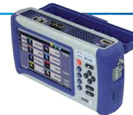
Le MX 300 est une plateforme de test ultra-compacte LAN/WAN 10 GE nouvelle génération pour les réseaux Ethernet transportant les services voix, données et vidéo.
