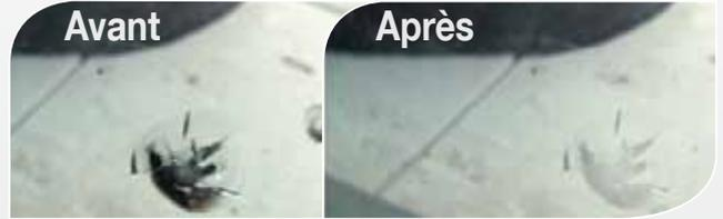
Dans un deuxième temps, la résine sera polymérisée sous rayonnement ultraviolet. La résine durcie et consolide le verre. Notre intervention permet de solidifier le verre tout en réduisant l'aspect inesthétique de l'impact.
