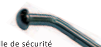
Goupille de sécurité - 2 par lisse ou longeron - 2 par entretoise de jumelage. Goupille de sécurité (Ø 6 mm)
