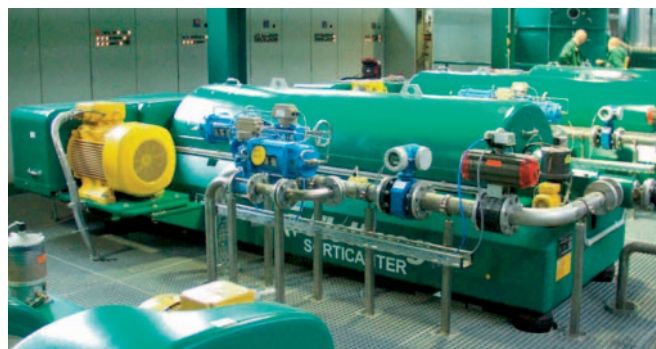
SORTICANTER® FLOTTWEG type K6E en recyclage plastique
