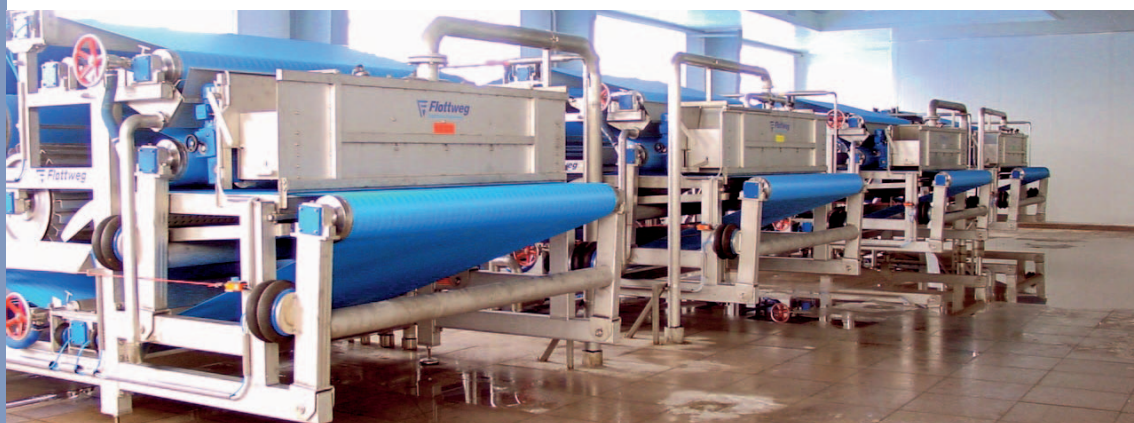
PRESSES À BANDES FLOTTWEG pour l'extraction du jus de pommes
