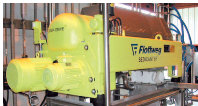
SEDICANTER® FLOTTWEG, type S4E en brasserie
