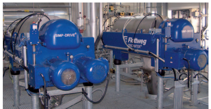
TRICANTER® FLOTTWEG type Z4E pour le traitement de boues huileuses
