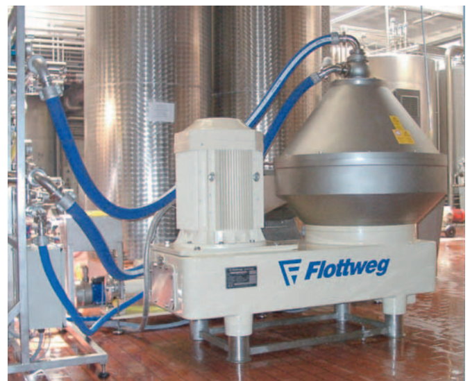
CENTRIFUGEUSE À ASSIETTES FLOTTWEG, type AC 2500 pour la clarification de jus de fruits et de vin
