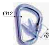
AZ014 alliage léger ouverture 25mm 113X73mm, 80 gr.
