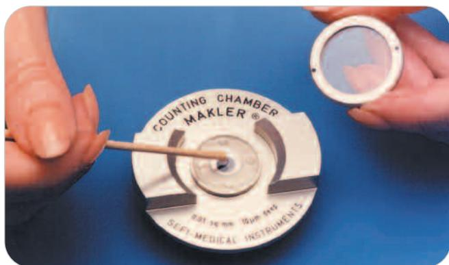
Cellule de comptage à profondeur déterminée pour l'obtention d'une mono-couche de spermatozoïdes.
