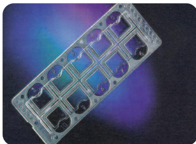
Lame en acrylique de haute qualité optique comportant 10 grilles à quadrillage pour la numération. Volume de chaque chambre de comptage avec
