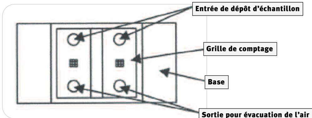
Cellules de comptage avec lame en verre ou en plastique et grille de Neubauer en plastique montée sur la lame. Dimensions de la lame : 25 x 75 mm pour le modèle en verre et 20 x 75 mm pour le modèle en plastique.
