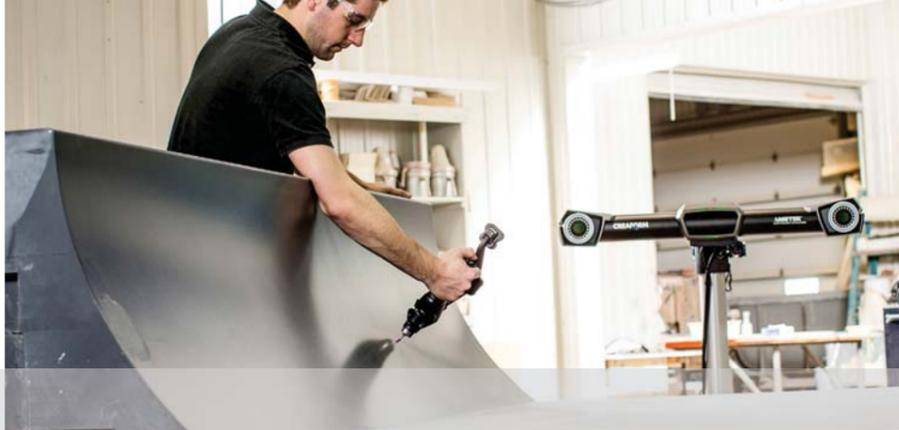
La **MMT optique portable HandyPROBE Next<sup>MC</sup>** propose une exactitude de mesure insensible aux instabilités de l'environnement. Libérés de tout montage de mesure rigide, la pièce, le capteur optique et le palpeur sans fil peuvent être déplacés à tout moment durant la séquence de mesure. Conçu spécialement pour une utilisation en usine, le système propose une flexibilité unique et un volume de mesure plus important que les autres MMT portables.
