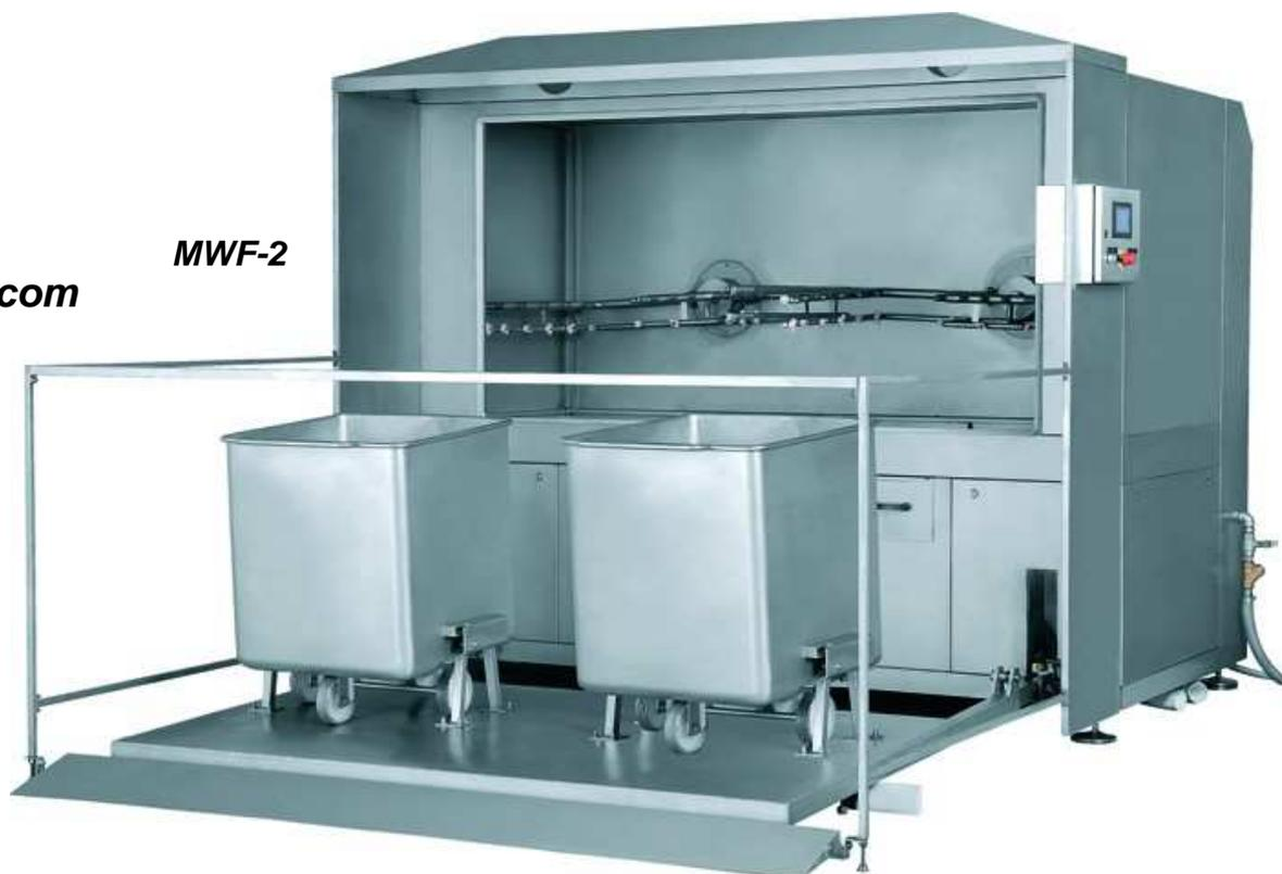
Cabine conçu pour le lavage la désinfection et le rinçage de chariot de fumages (chargement jusqu'à 9 chariots).
