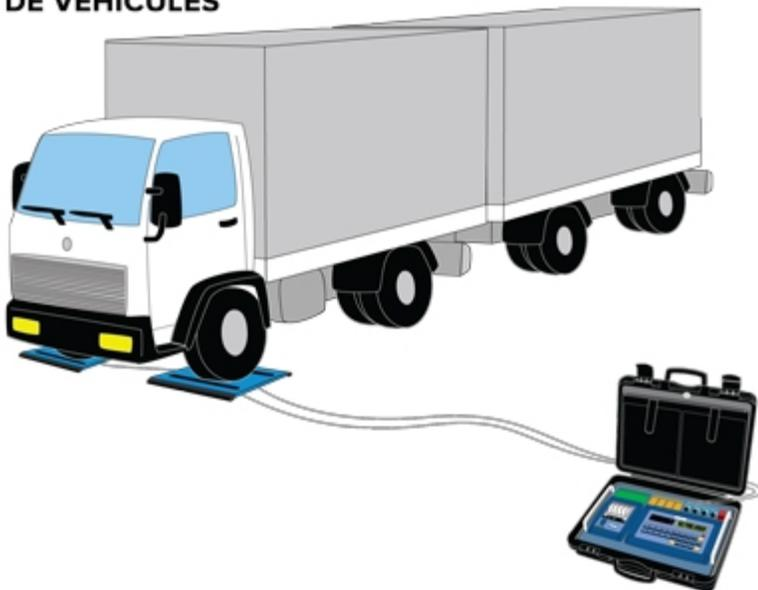
Logiciel approprié pour les applications avancées du pesage et de la totalisation des essieux pour le contrôle du poids des véhicules ou pour le pesage entrées / sorties.
