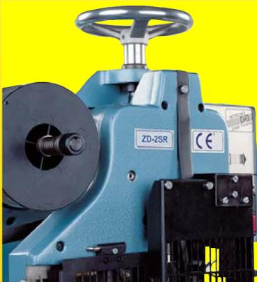
*Simultanéité des réglages de la pression et de la longueur de l'agrafe par volant.*
