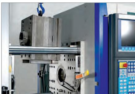
**Simple et rapide, le système manuel à baïonnette vous permet de brider vos moules en une seule action à l'aide d'un levier de manœuvre amovible.**
