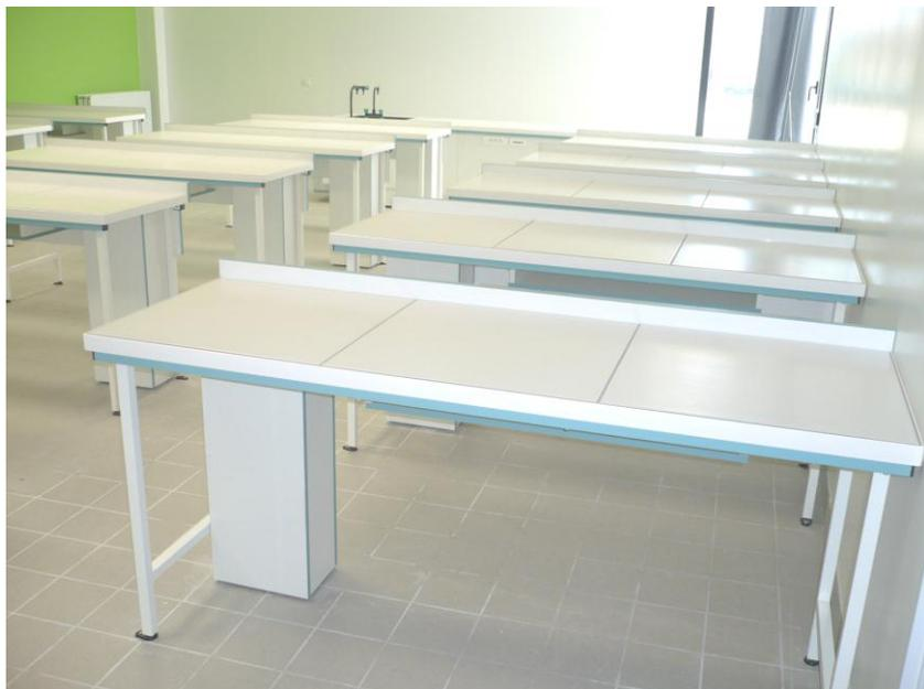
La paillasse élève sèche est composée d'un plateau fixé sur des longerons métalliques colorés en tube 30 x 30, le tout monté sur piétements coloris blanc.
