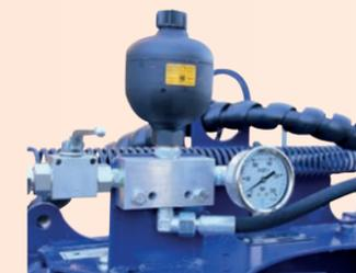
Réglage de la dureté d'effacement
