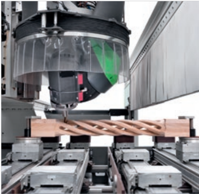
Unité de fraisage à 5 axes avec coiffe réglable en hauteur de 360 mm.
