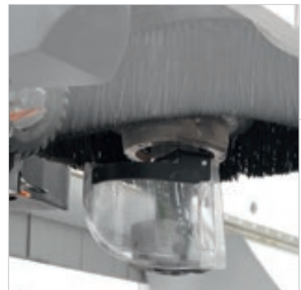
Défecteur intégré (transporteur de copeaux) géré par contrôle numérique.
