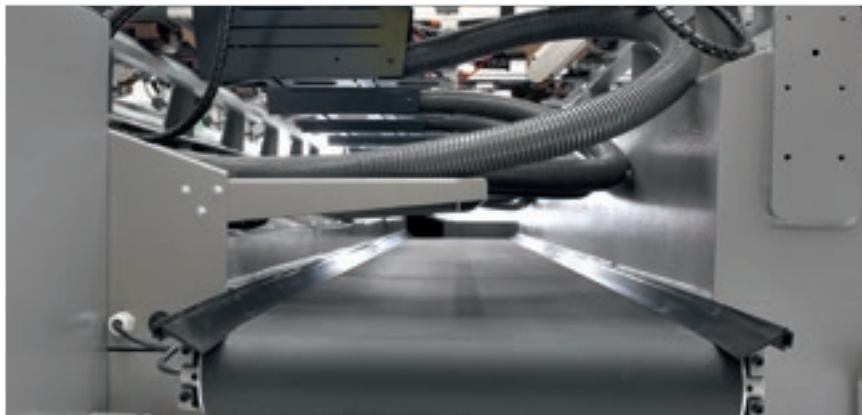
Tapis motorisé pour l'évacuation de copeaux et de déchets.
