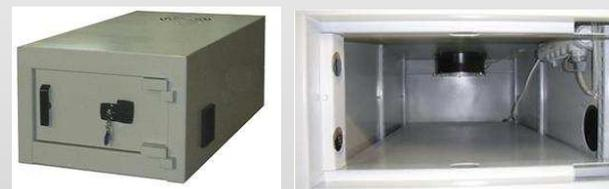
Coffre-fort ventilé H 400 x L 600 x P 1100 mm sur base de coffre acier 4 mm et porte épaisseur 8 mm avec serrure à clé double panneton 14 gorges
