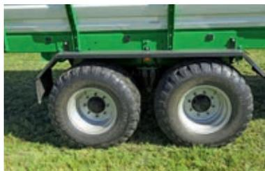
Châssis tandem suspendu
