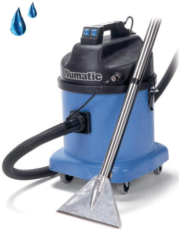
Aspirateur eau et poussières, injecteur/extracteur : La solution eau-produit est directement injectée sur la surface à traiter pendant que l'eau sale est aspirée vers la cuve. Aspiration et injection se font ensemble ou séparément.
