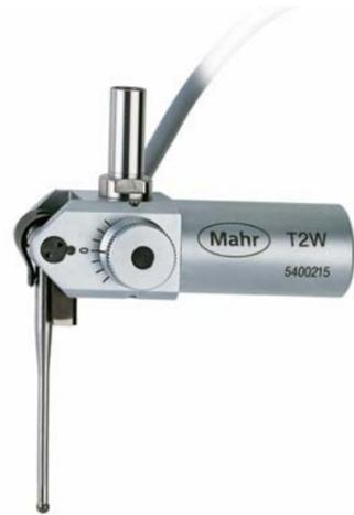
Le **palpeur de mesure T2W**, à fonctionnement inductif, est utilisable pour des pièces très variées. Le bras de palpation mobile dans une plage angulaire de 180° et les différentes possibilités de serrage du palpeur permettent d'effectuer des mesures même dans des endroits difficilement accessibles. Pour adapter le palpeur aux tâches de mesure ou aux pièces, vous pouvez combiner des bras de palpation facilement interchangeables avec différents éléments de mesure.
