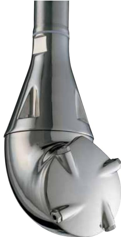
Les Têtes à jets rotatifs Toftejorg nettoient les cuves en projetant des jets de liquide de lavage contre les parois. Le débit de liquide à travers la turbine et les pignons provoque la rotation des buses autour des axes horizontaux et verticaux.
