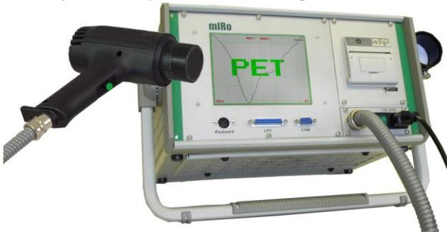
Le principe est basé sur la spectroscopie proche infrarouge de réflexion diffuse, incluant une base de données spécifique, unique et un modèle mathématique très puissant. On émet une lumière infrarouge sur l'échantillon de plastique et par analyse de la lumière réfléchi on en déduit la nature de l'échantillon grâce au détecteur proche infrarouge et via traitement par un réseau neurologique.
