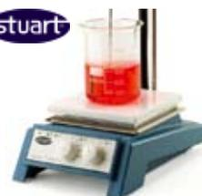
Détecte la présence du thermomètre et change de mode de régulation • témoin « Hot » de plaque chaude dès  $50^{\circ}\text{C}$  • conception anti-débordement • protection contre la surchauffe.
