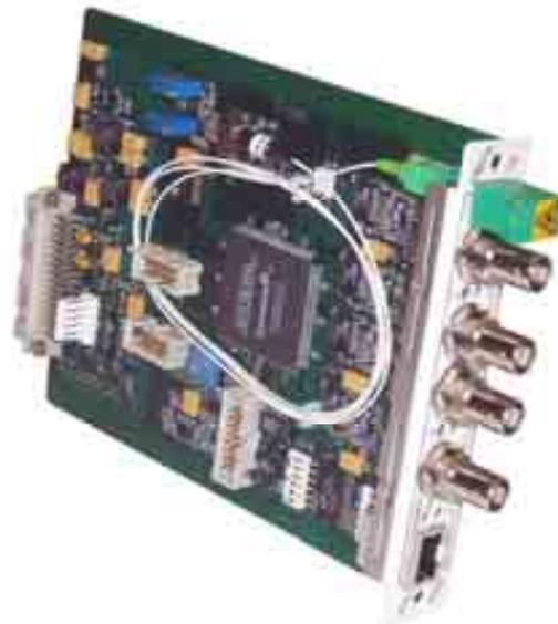
Les **ERC 4000** sont des équipements de transmission bidirectionnelle. Ils permettent de transmettre les signaux vidéo, données et TOR sur une fibre optique.
