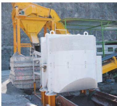
BMS propose des séparateurs à courant de Foucault universels et performants conçue pour l'extraction des métaux non-ferreux.
