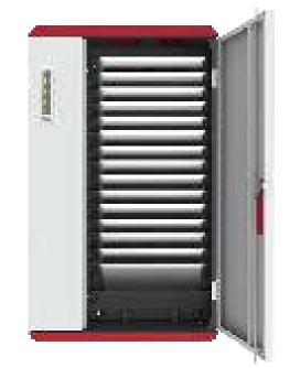
Chargement et synchronisation filaire, USB Type C & PD3.0, fournissant 6 types de réglage de puissance, SV, 9V, 10V, 12V, 15V / 3A ou 20V / 2,25A pour chaque port USB
