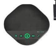
Pour des salles de 80-100m², jusqu'à 15 participants. Rayon de prise de voix : 8 m. Fréquence micro et haut-parleur : 120 khz-22 khz. Volume de HP max 98 db. Distance de transmission sans fil 2.4 GHZ de 15m. Veille 4-5 jours
