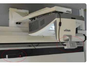
Un boitier infrarouge / rideau laser en connexion sans fil à la caméra. Il est placé dans la surface du
