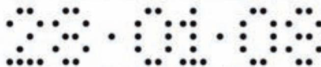
hauteur des caractères 10 mm, diamètre d'aiguille 1.1 mm
