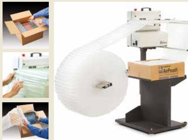
Le système de calage FastWrap, produit des nappes de bulles et des tubes servant aux différentes applications d'emballage.
