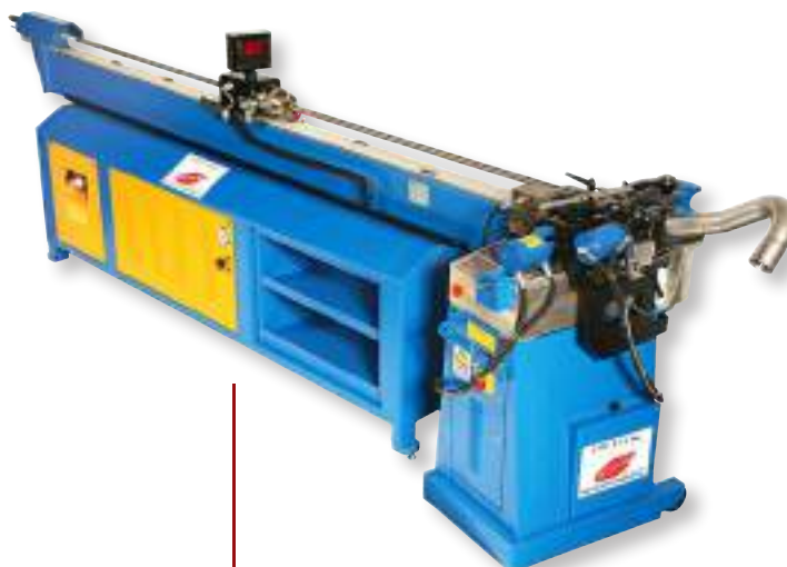
Cintreuse avec mandrin De Ø10 au Ø280mm
