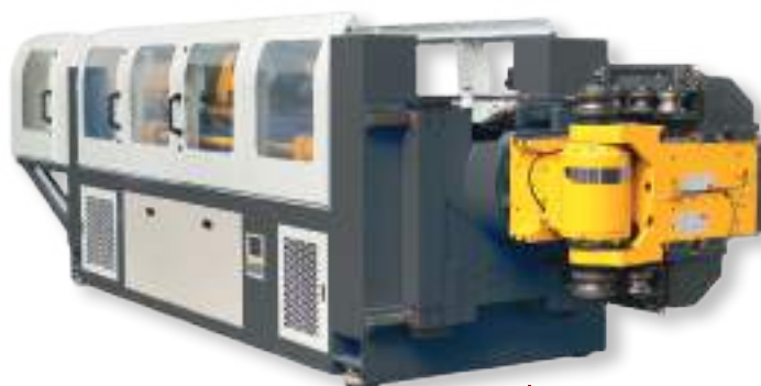
Cintreuse Électrique De Ø15 à 100mm Gauche-Droite avec roulage
