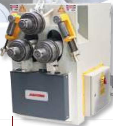
Cintreuse à galets Arbre de Ø30 à 360mm
