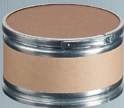
Le fût kraft, appelé également « fût fibre », est composé de papier kraft liner. Le sertissage (haut et bas) est réalisé par un feillard métallique galvanisé. Fermeture par couvercle plastique ou métallique + collier à levier.
