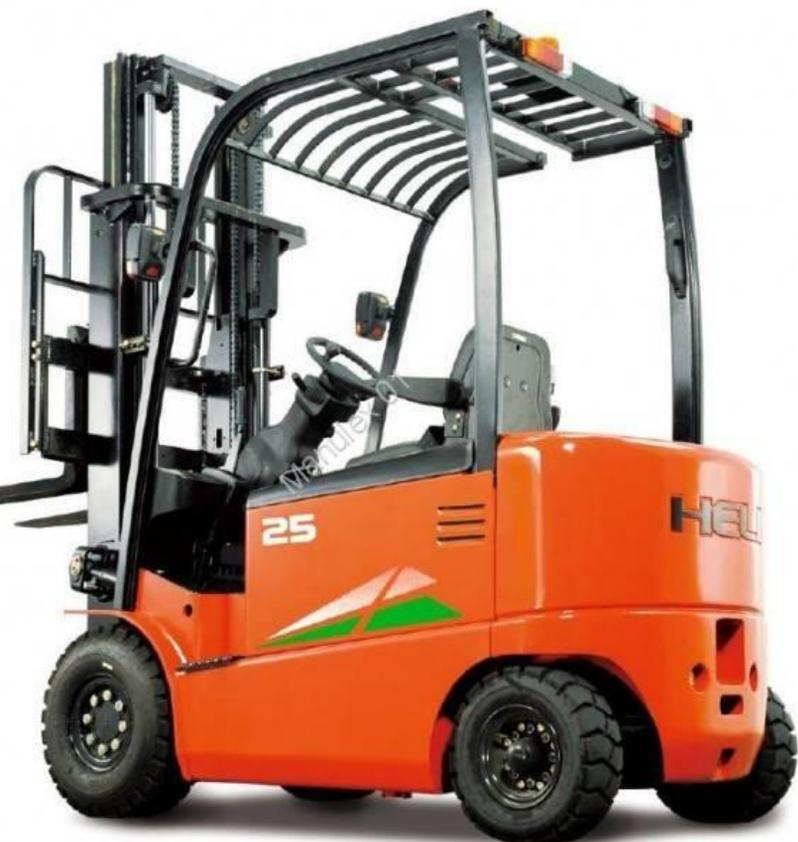
Moteur de traction AC et moteur de pompe AC de type asynchrone sans balais
