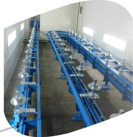
**Convoyeur passant dans four très haute température**
