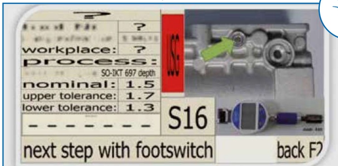
① exemple d'une gamme de contrôle avec DIA-Gauge Esempio di "Sequenza guidata" con software DIA-Gauge
